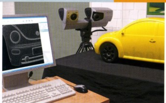
High-End-Projektionsscanner: Diese erstellen beim 3D-Digitalisieren im Kundenauftrag präzise Datensätze für das Reverse Engineering und die Vermessung – und sind hier gerade im Einsatz beim Scannen eines Pumpenlaufrads und der Frontansicht eines Automodells.
